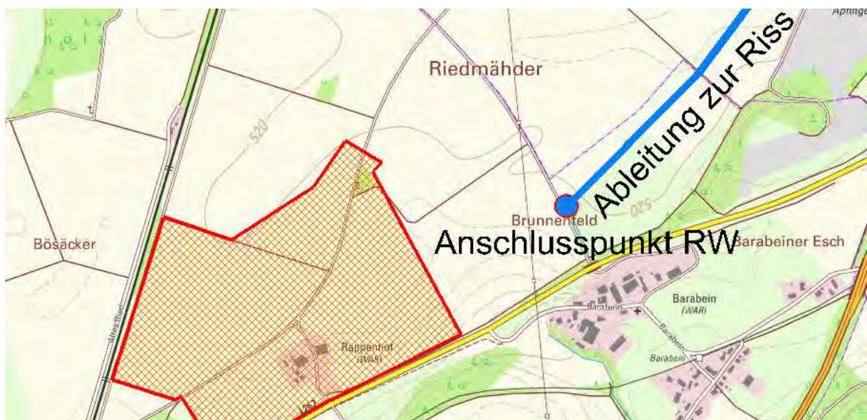
Anschlusspunkt für Regenwasser Drossel-/Überlaufwasser aus den Versickerungsmulden an den „Unterriedgraben“
